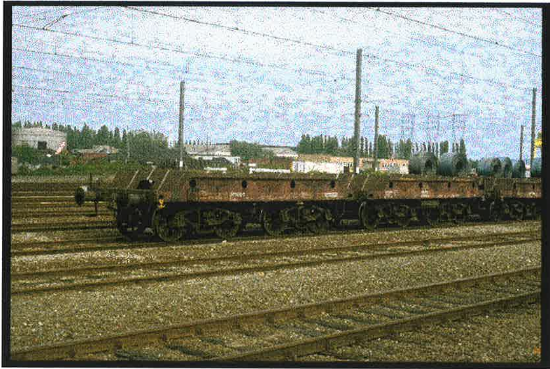
Transportwaggen voor coils afgesteld te Bressoux J. Casier
