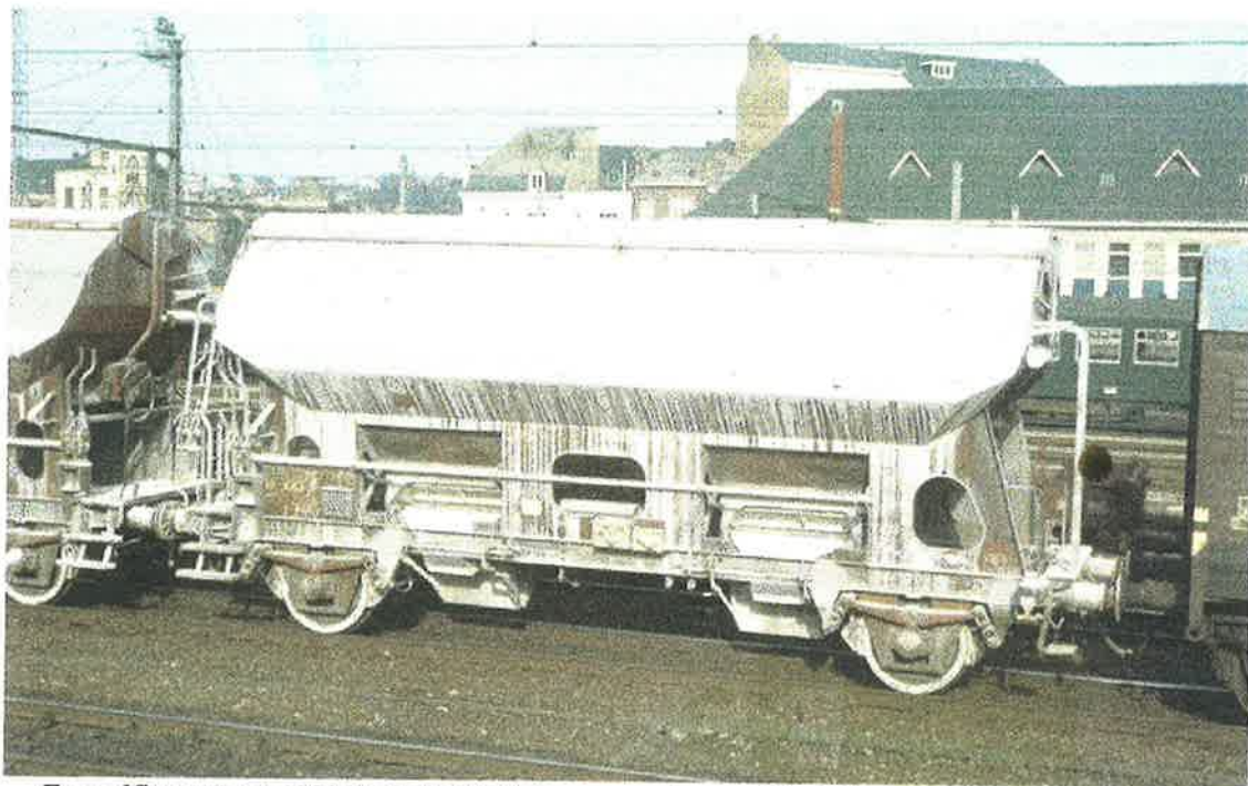
Een zelflosser type 1000 D6 in het kalkvervoer op de maaslijn te Namur
